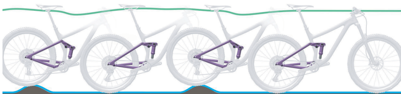
Abbildung 20: Optimales Fahrverhalten des Hinterbau-Dämpfers
