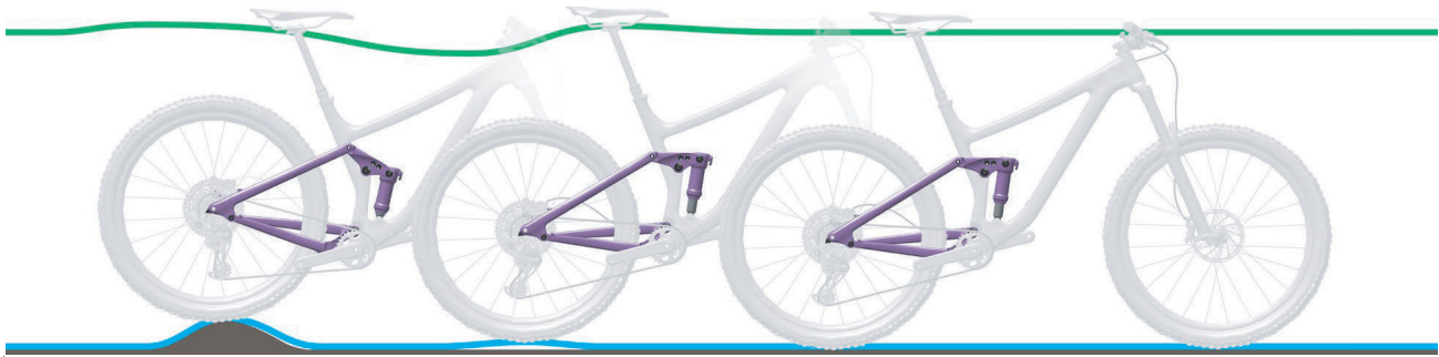
Abbildung 226: Zu schnelles Ausfedern des Hinterbau-Dämpfers
