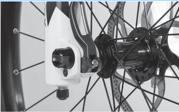
Abbildung 63: Perfekte Lage des Spannhebels
