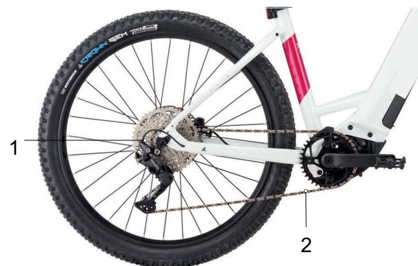
Abbildung 35: Schema Kettenantrieb mit Kettenschaltung
