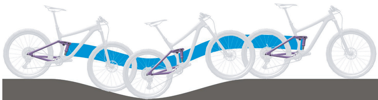
Abbildung 21: Optimales Fahrverhalten des Hinterbau-Dämpfers im hügeligen Gelände
