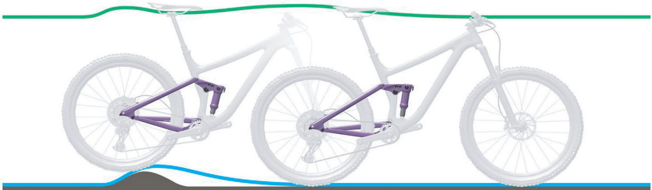
Abbildung 232: Zu harte Dämpfung des Hinterbau-Dämpfers bei Unebenheiten
